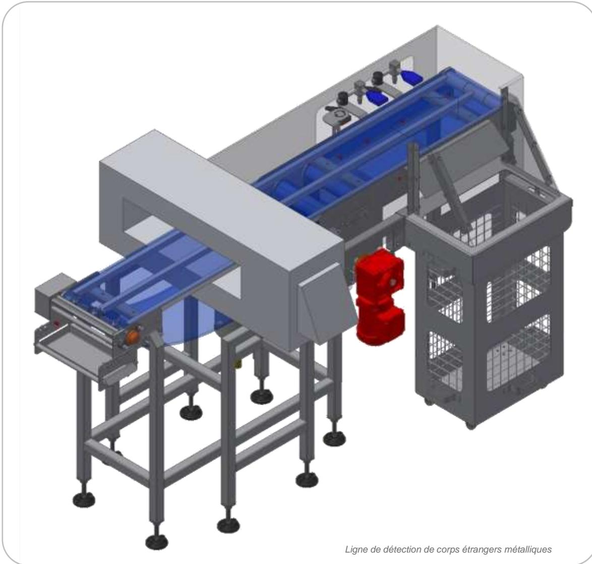
Ligne de détection de corps étrangers métalliques
