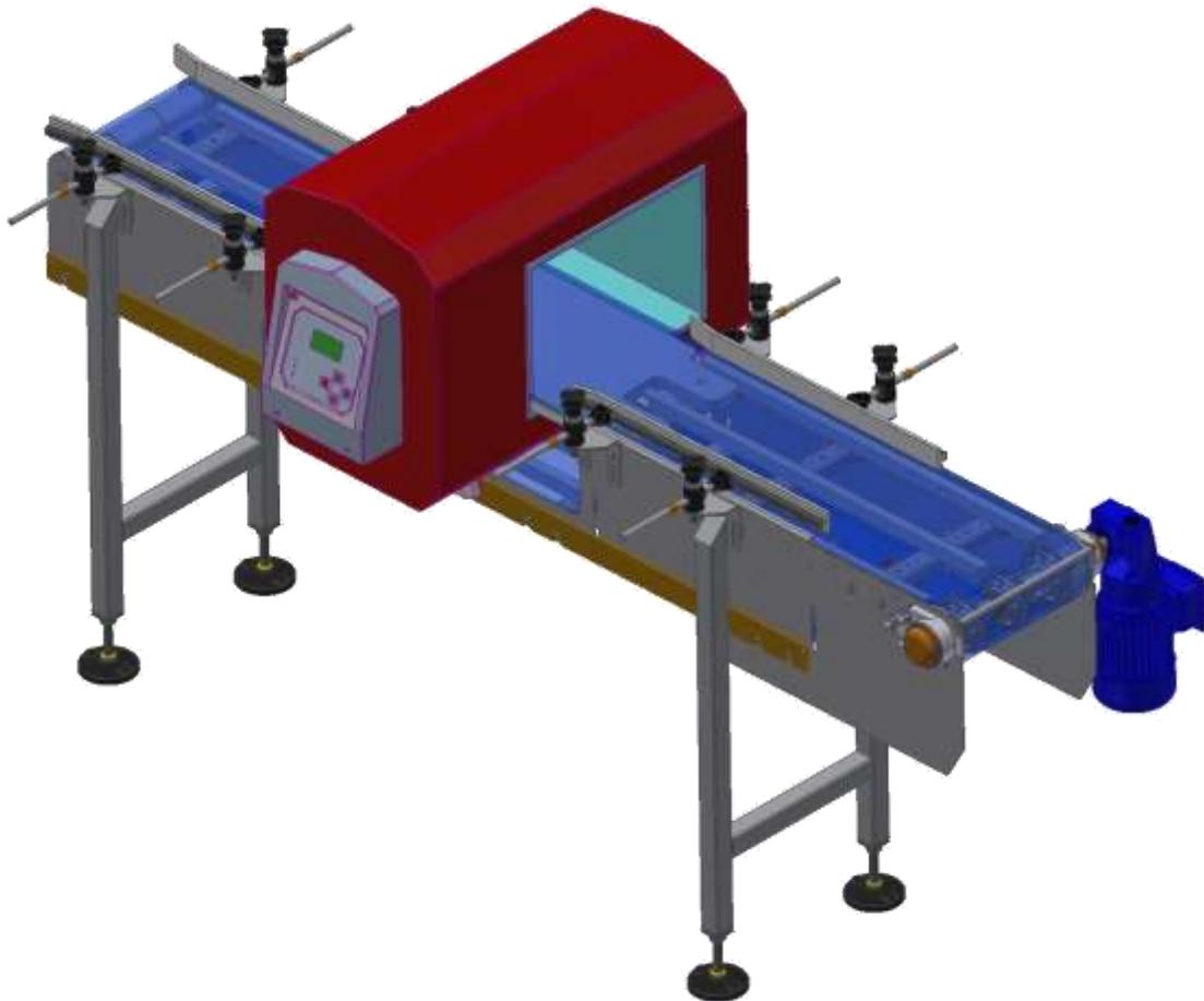
Ligne de détection de corps étrangers métalliques
